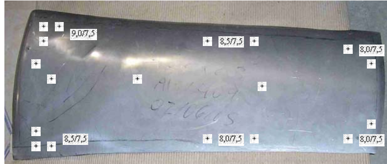
Figura 11. Pontos de medição das deformações e alguns valores encontrados. Feroni (2005)
