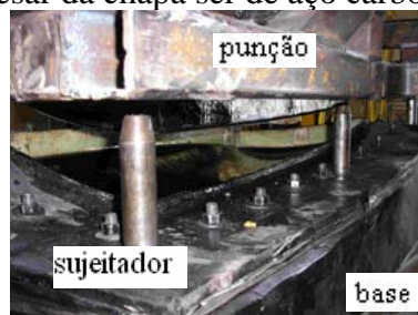
Figura 6. Chapa 2 conformada depois da retirada do punção. Foroni (2005)
