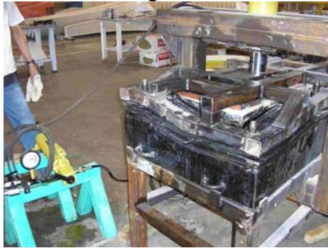
Figura 4. Conformação da Chapa 1 pelo Punção. Foroni (2005)
