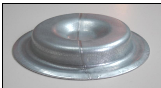
Figura 4 – Forma Final da Peça Estampada com Raio de 5mm
