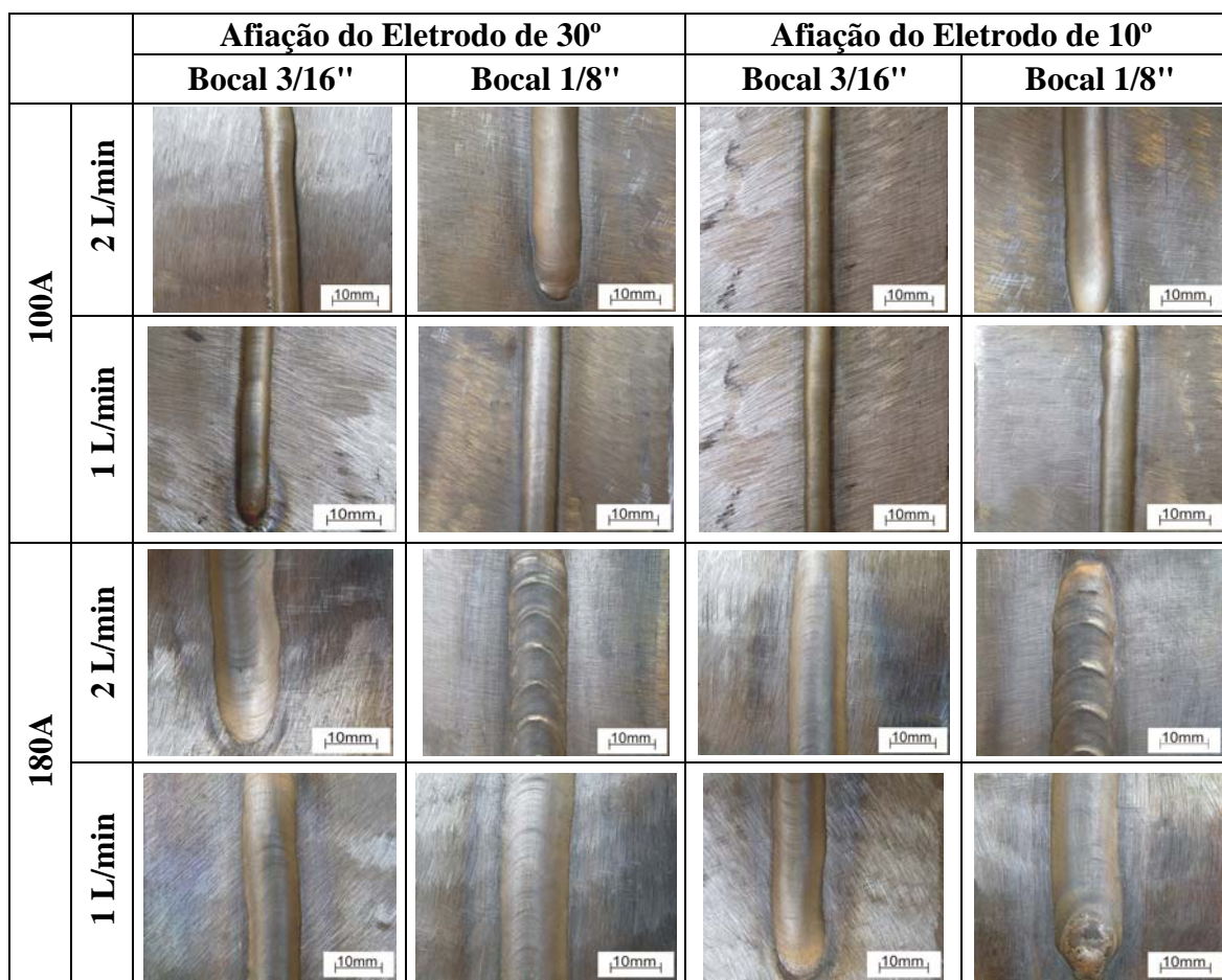
Figura 4. Análise superficial dos diferentes cordões conforme intensidade de corrente, ângulo de afiação do eletrodo e vazão de gás
