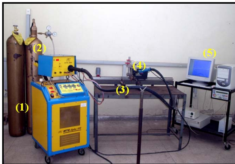
Figura 1. Bancada de soldagem utilizada para a realização dos experimentos, onde (1) Fonte de potência, (2) Cabeçote alimentador de arame, (3) Tocha, (4) Sistema de deslocamento automático da tocha de soldagem, e (5) micro-computador.
