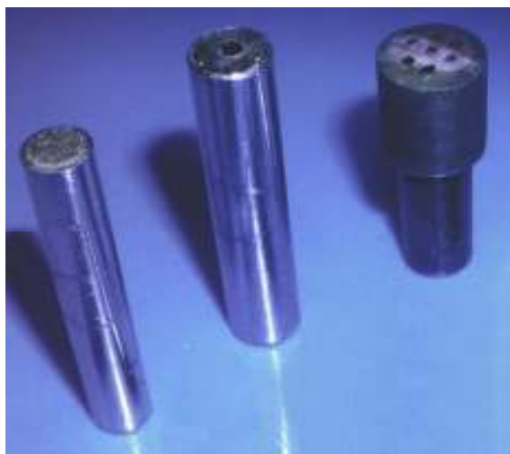
Figura 4. Variações dos dressadores construídos na UENF.
